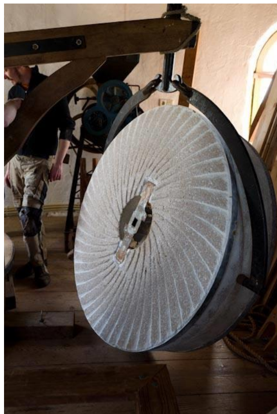
De 1200 kilo zware loper (bovenste, draaiende steen) hangt in de steenkraan. Het groevenpatroon (scherpsel) is goed te zien.
