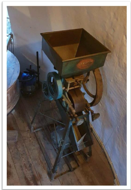
Zicht vanaf de trap op de pletter. Begin 2019 zal er nog een houten stortkoker worden gemaakt, zodat de trechter (kaar) eenvoudig gevuld kan worden.
