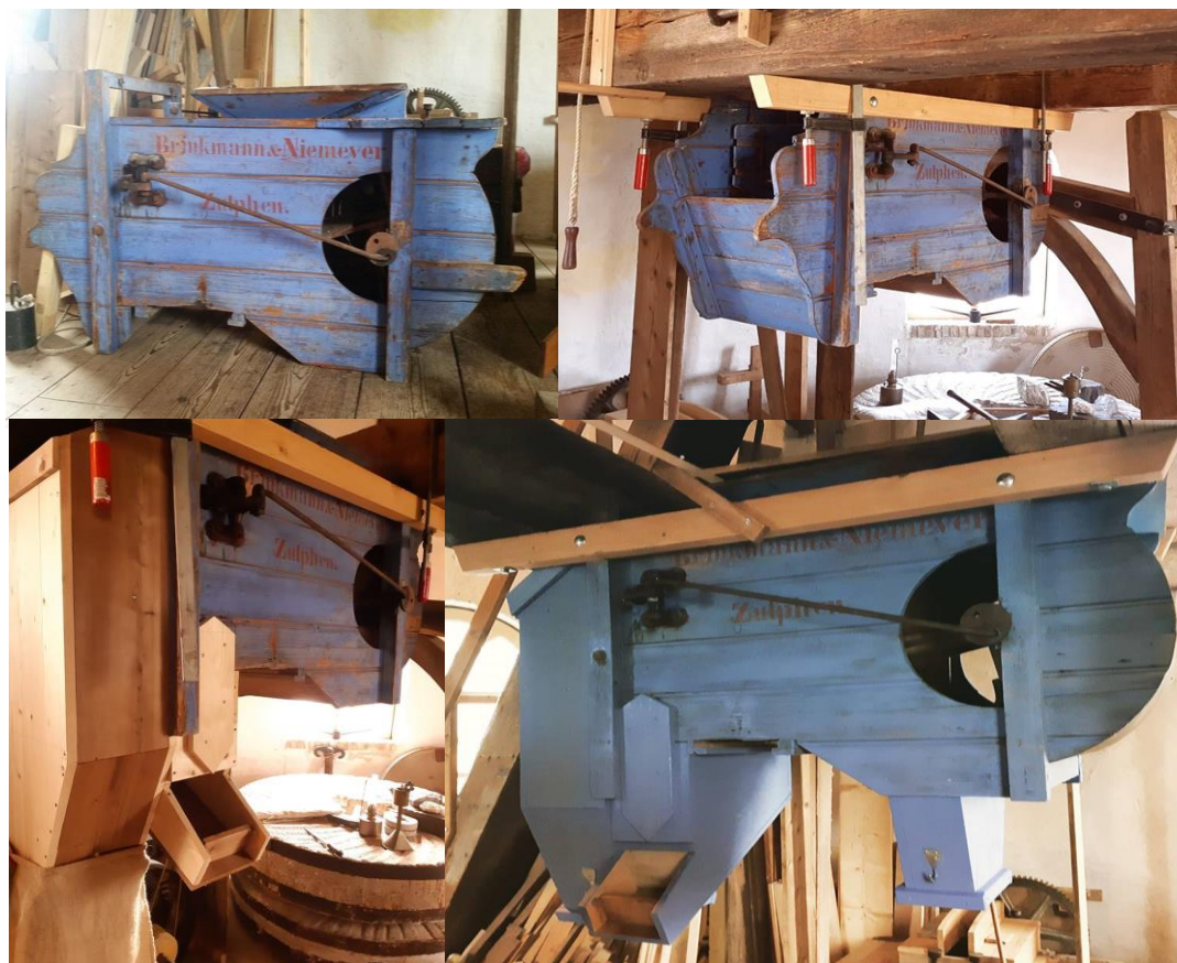
Fotocollage van de opbouw van de graanschoner. De inbouw is op enkele details na afgerond.
